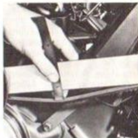
Fan Belt Tension
