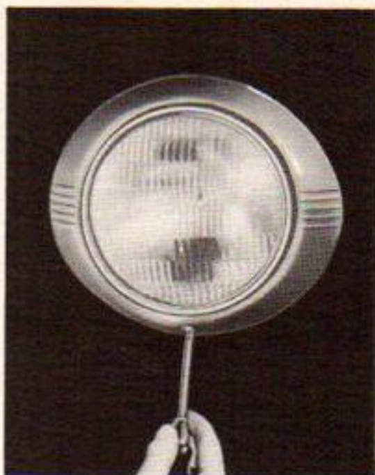
Fig. 37—Remove Headlamp Door Rim
